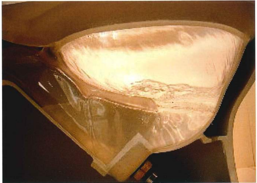
これはトイレの中の水の流れ。通常13リットルの水が必要。 節水型は8リットル。現在6リットルが目標という。
