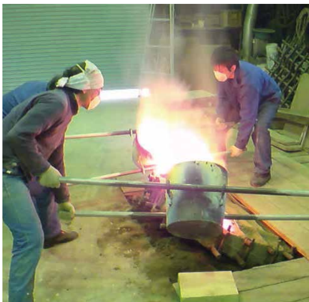
慎重に行われる1,200℃の液体になったブロンズの流し込み(櫻井美術鑄造)
