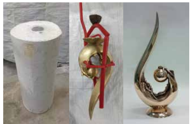
左:石膏鑄型、中:湯道を切る前の作品、右:完成品
